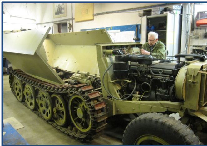
2 fotos fra den senere del af renoveringen, hvor vognen bl.a. fik helt nyt ledningsnet
